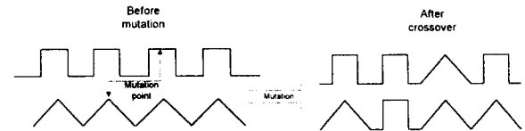
그림 5 돌연변이 연산자의 작동원리 Fig. 5 The principle of mutation operator
