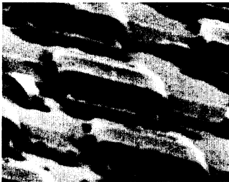
그림 8 Passivation oxide를 형성한 후, 기계적인 스트레스를 가한 air-bridge 교차 구조
