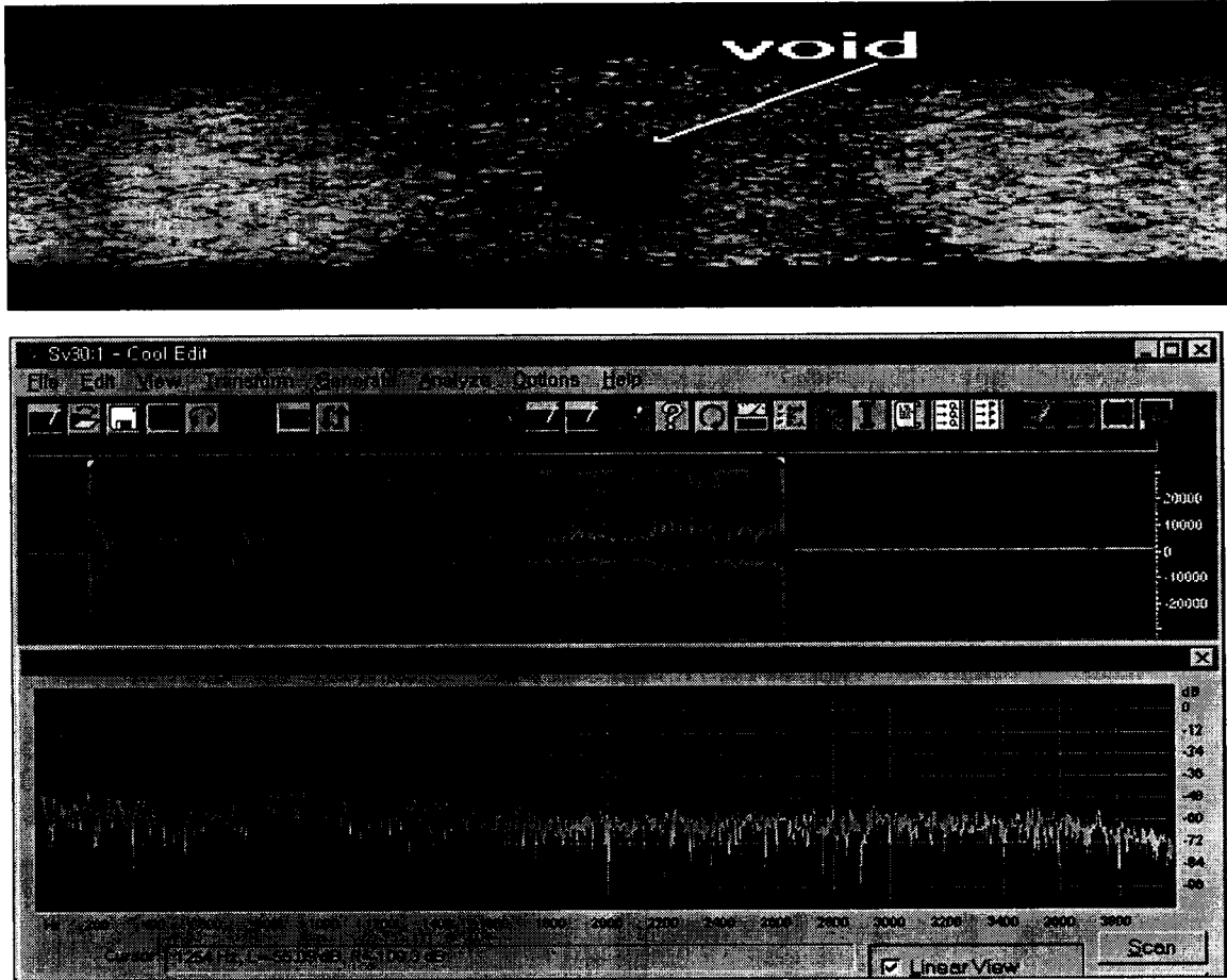
(c) C3 : Porosity → 상 : 용접비드 형상, 중 : 광센서 출력, 하 : FFT data
