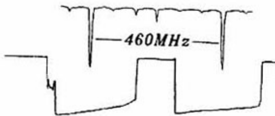
그림 2 고리형 증폭 공진기를 통과한 투과곡선. 공진기 내부에 결정이 없을 때(위), 있을 때(아래).
