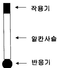
그림 2. 자기조립 단분자 막 제조에 이용되는 분자의 구조.
