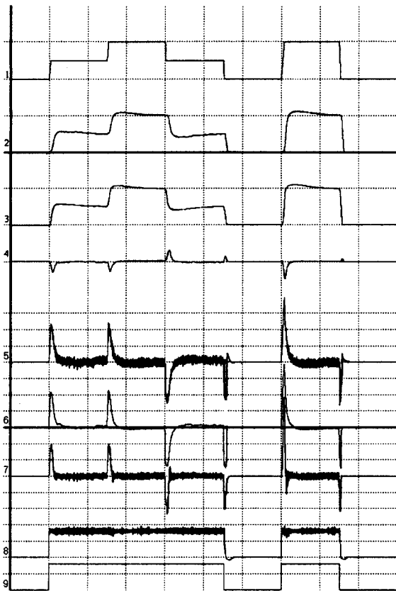
그림 16 저속영역동작 시뮬레이션 파형 (1:기준속도, 2:추정속도, 3:실제속도, 4:속도오차, 5: i_{sd} , 6: i_{sq}^* , 7:발생토크, 8: i_{sd} , 9: i_{sq}^* , 50rpm/div., 20A/div., 28Nm/div., 20s/div.)
