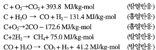
즉 폐기물의 열분해에 의해 CO, H<sub>2</sub>, CH<sub>4</sub> 등의 가연성 가스를 생성시키는 것을 전류 가스화(Dry Distillation Gasification)라 한다.
