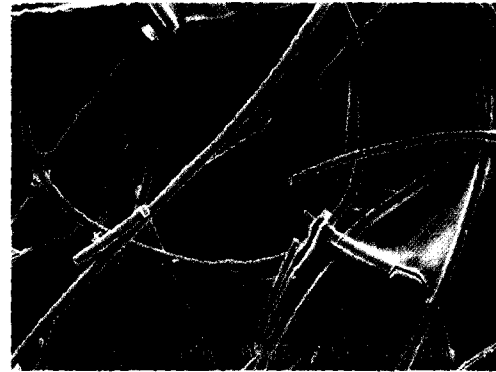
Figure 6. PLGA 용액을 담구어 증발시키는 방법으로 PGA 부직포를 결합한 전자현미경 사진.
