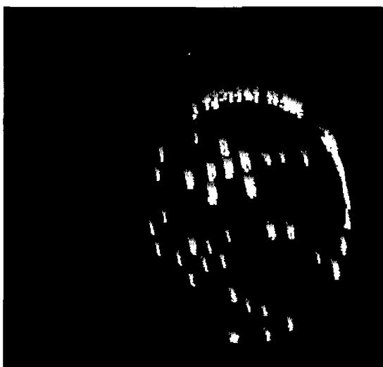
그림 6. 제안한 알고리즘 수행과정에서 특징점 궤적상에 생성된 거리 변환 필드. Fig. 6. Distance potential field developed on the trajectories of feature points.
