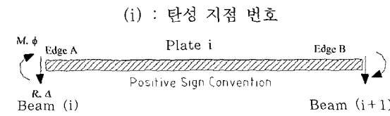
그림 4 탄성 지지된 등방성판의 부호 및 기호정의
