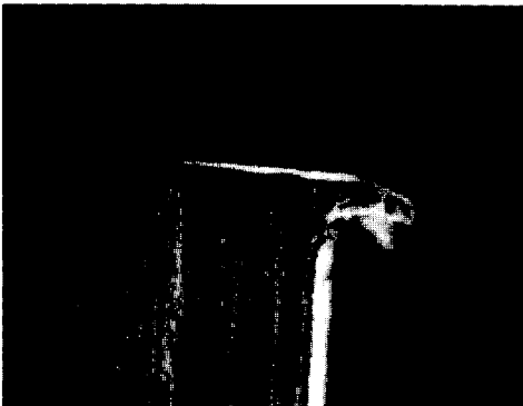
Burr Specimen (Burr Height = 0.5mm)
