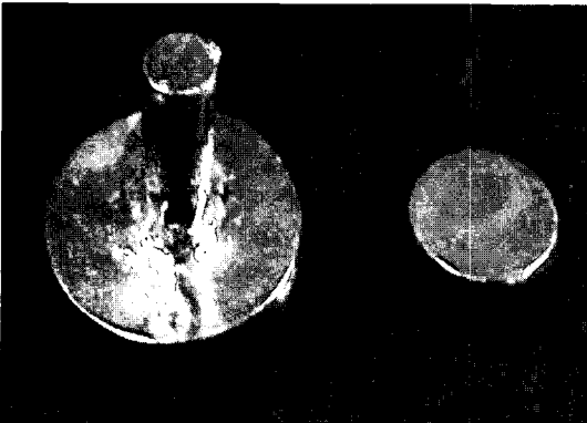
Fig. 3. Pairs of metal specimens(Ø10×h 2mm, Ø6×h 2mm).
