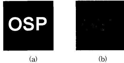
그림 7. 재생된 영상 (a) 복소값으로 재생한 경우 (b) 위상만으로 재생한 경우 Fig. 7. The reconstructed image. (a) recovered using complex value (b) recovered using only phase
