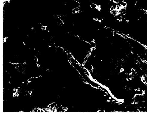
Fig. 1. SEM of MCC powder.
