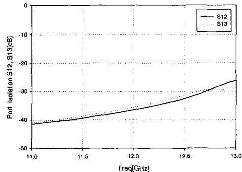
그림 3. Sequential 회전을 위한 3개의 정삼각형 패치의 포트간 분리도(S12, S13)
