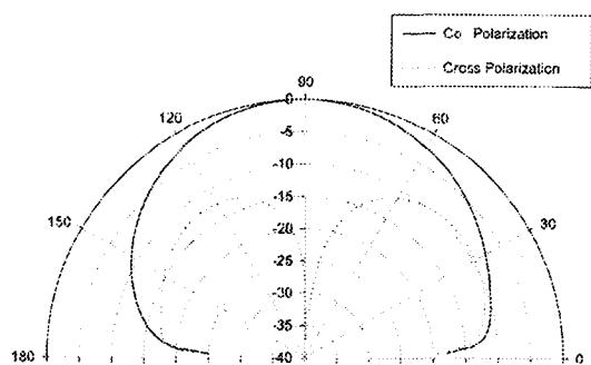
그림 4. Sequential 회전에 의한 cross 편파의 감소
