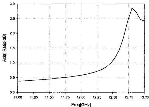
그림 5. Sequential 회전에 의한 AR (시뮬레이션 결과)
