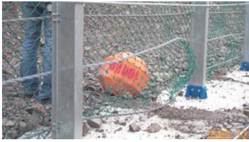
(a)콘크리트 볼(100kg)이 와이어에 부딪힌 경우
