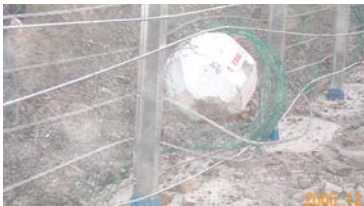
(c)중량 1,000kg 콘크리트 볼에 의한 손상정도
