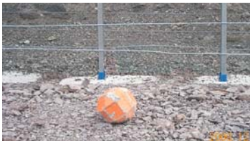
(b)콘크리트 볼(100kg)이 철망을 뚫고 나온 경우
