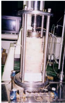
그림 17. 삼축압축시험 완료 후 시료의 변형된 모습
