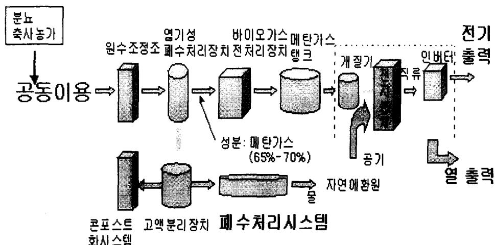
가축분뇨 유효이용(메탄가스를 이용한 전기 및 열생산 시스템)<sup>3)</sup>
