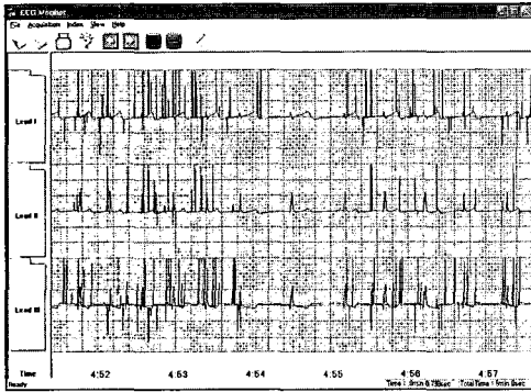
그림 5. 측정부와 출력부사이의 거리가 멀어진 경우의 ECG 파형.
