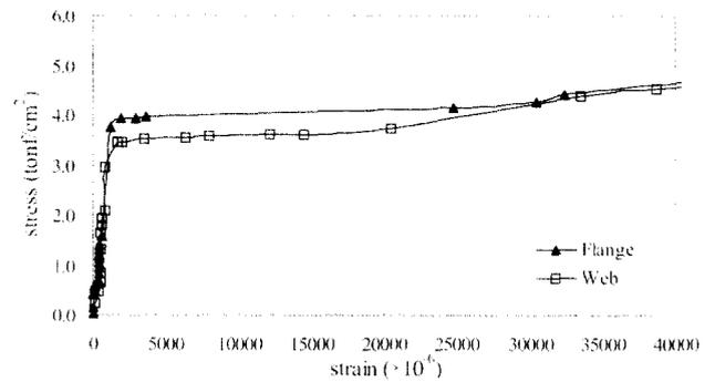
그림 4. 재료의 응력-변형률 관계
