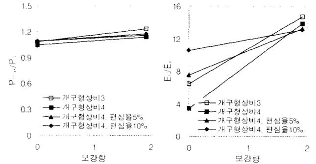
그림 16. 보강재 유무에 따른 항복비 및 에너지변화량
