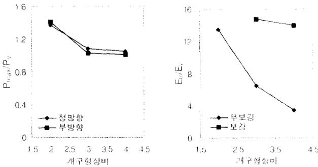
그림 11. 개구형상비에 따른 항복비 및 에너지변화량
