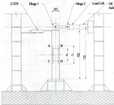
그림 5. 실험체 가력 및 측정 장치
