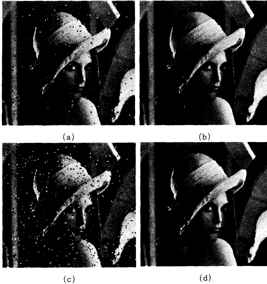
그림 9. 레나 이미지는 VQ 부호책(N=256)으로 부호화되고, 잡음 채널에서 전송된다. (a)와 (c)는 기존의 시스템(VQ+QAM)으로 수신된 데이터를 재구성한다. (b)와 (d)는 제안된 시스템(COVQ+O-QAM)으로 재구성하였다. 잡음 채널에서 CSNRs은 각각 (a)와 (b)에서 30.26 dB, (c)와 (d)에서는 28.50 dB이다.
