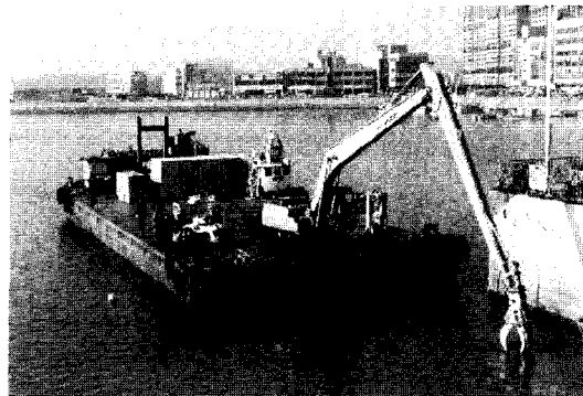
그림 12. 다기능 해양폐기물 전용 수거시스템
