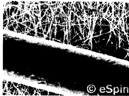
그림 3. 전기방사된 나노섬유와 인모의 전자현미경 사진.
