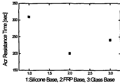
그림 12 RTV 코팅 기저 물질에 따른 내 아크 특성 Fig. 12 The arc resistance of RTV coating with base materials
