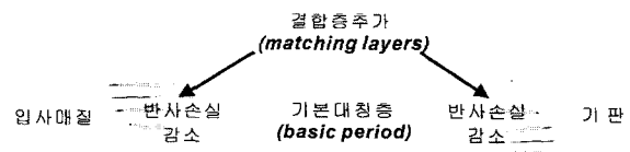
그림 10. 결합층 설계-기본 대칭층과 주변매질과의 굴절률차에 의한 반사손실을 감소.
