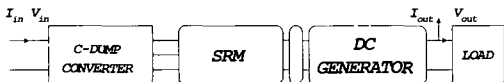
그림 4-8 부하 실험을 위한 시스템의 구성도 Fig. 4-8 SRM system block diagram for measuring Load
