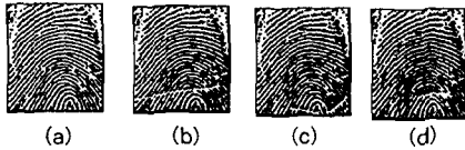
그림 9. 이진 이미지의 형태상 이미지 Fig. 9 Morphological filter image of binary image
