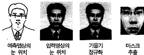
그림 5. 예측맵을 이용한 얼굴영역 추출 과정 Fig. 5 Face detection process with forecast map
