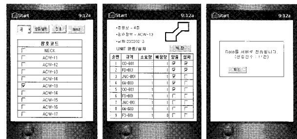
그림 12 현장 관리자가 휴대하는 PDA를 사용하여 커튼월 부재 설치 및 양중작업 결과를 전송하는 화면
