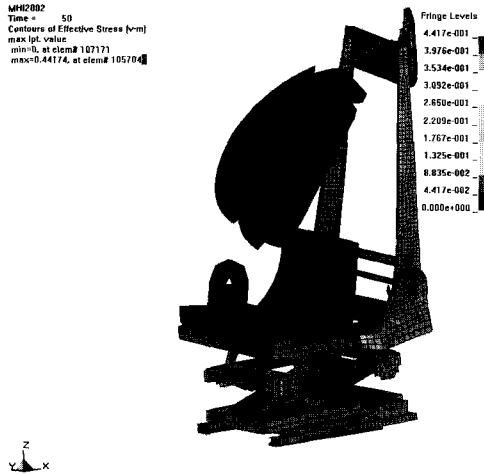
그림 3 Dynamic transient result at 50msec - stress
