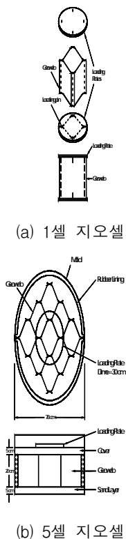
그림 4. 지오셀 일축 압축 강도 시험 개략도
