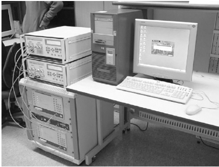
[그림 2] CDG Stage 2 시험장비 구성(RACAL Instruments 1X-AIME)
