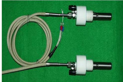
그림 5. 제작한 파울링 센서 외형
