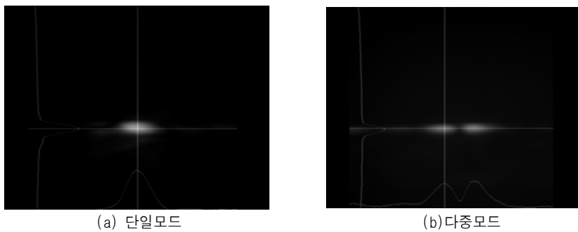
그림 8. 형성된 도파로의 광모드 측정 결과
