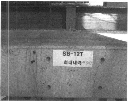
사진 2. SB-12T 실험체의 가력종료 상황
