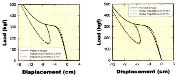
그림 12. Mast #18, 수평·수직방향 하중-변위곡선(Type-B)
