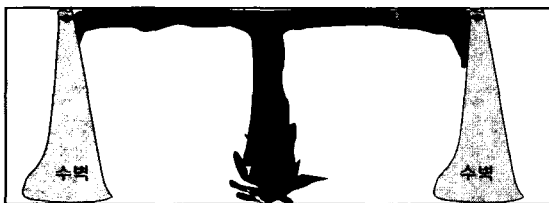
그림 1. 터널화재시 수막에 의한 연기확산방지시스템의 기본구성도
