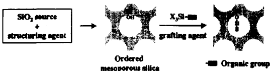
그림 13. 메조포러스 실리카에 합성 후 처리에 의해서 메조포어 벽에 유기적 기능기의 표면에 그래프팅. 16-17
