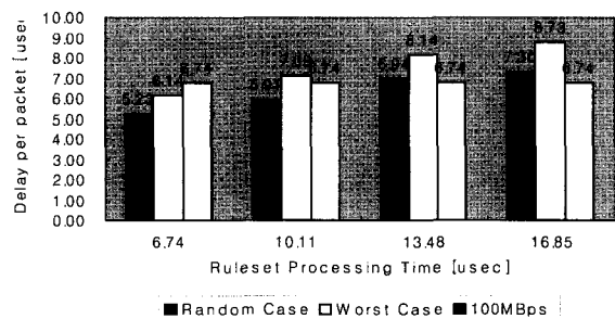
그림 8. 여과 규칙 수행 시간에 따른 패킷 당 수행 시간 Fig. 8. Processing time per packet.
