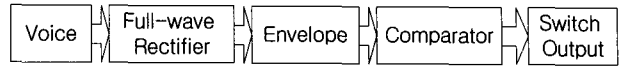
그림 7. 음성 신호를 이용한 스위치 제어의 구성 Fig. 7. Block diagram of Voice switch.
