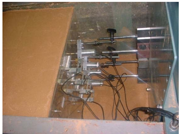
(c) LVDT 설치
