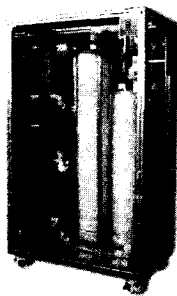
그림 6. 반도체 공정용으로 개발한 오존접촉장치 Fig. 6. Developed ozone contactor for the semiconductor manufacturing process.
