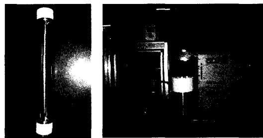
그림 7. 개발한 70[g/hr]급 오존발생장치 및 시험장치 Fig. 7. Developed ozone generator of 70[g/hr] and experimental set-up.
