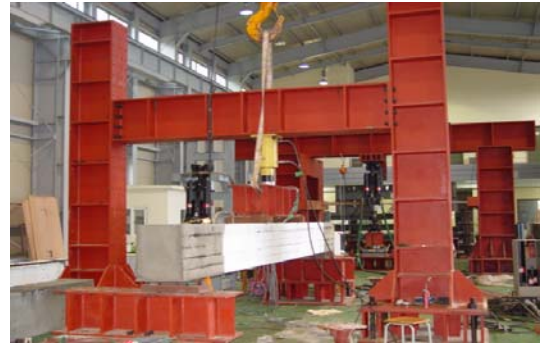
Photo 1 RC 보의 휨실험 전경
