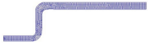
(d) Mesh deformation of 4th-drawing
