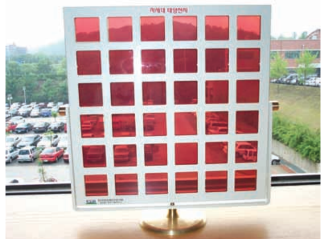
한국전자통신연구소에 개발한 투과율 65%의 염료 태양전지창. 이를 크게 만들면 유리창 겸용으로 사용할 수 있다.
