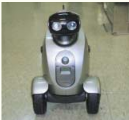
〈그림 2〉 SK텔레콤은 지능형 로봇이 집안 곳곳을 돌아다니며 화재나 가스누출 등 위급상황 발생시 집안 상황을 휴대폰으로 전송해 주는 신개념 홈네트워크 서비스를 개발하고 있다.
