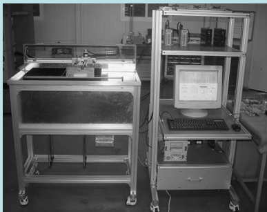
그림 3. 오피스용 시뮬레이터 (좌: 시뮬레이터 기구부, 우: 제어부)
