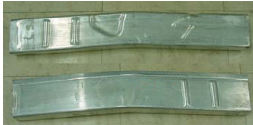
그림 15. 하이드로포밍 후 제품의 성형 상태
