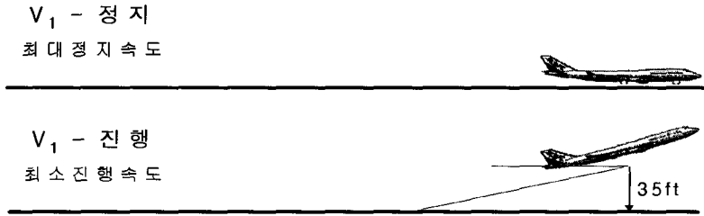
〈그림 1〉 이륙단념속도( V_1 )의 두 가지 개념(미국 FAR 정의를 연구자가 도식화)
