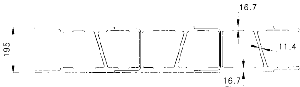
그림 5 듀라스팬 바닥판의 단면형상 (단위 : mm)
